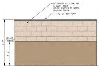
3 SIDE ELEVATION SCALE: 1/2" = 1'-0"
